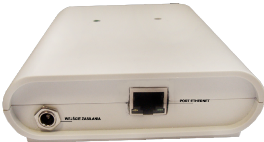
Rysunek 1.4: ICP widok z boku – port RJ45 Ethernet oraz wejście na zasilacz
